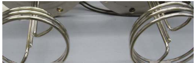
Abb. 3: Heizungen vor dem Gerätetest.
